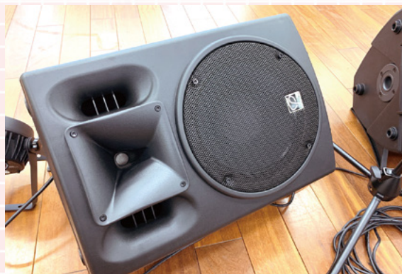
⑦ PA スピーカーをフロア用（足元）のモニタースピーカーとして使用しているケース。 各パートのメンバーの立ち位置に合わせて向きを調整しよう
