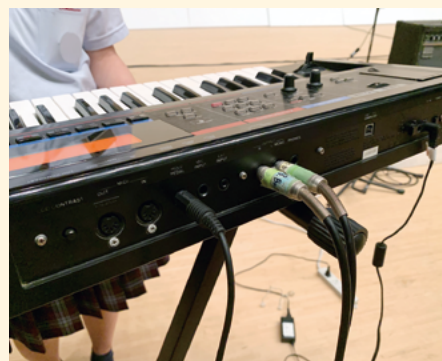
▲キーボードはDIを2つ使ってステレオで出力します
