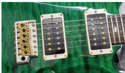
◀ 代表的なピックアップ。シングルコイル・タイプ（左）とハムバッカー・タイプ（右）の一般的な形状
