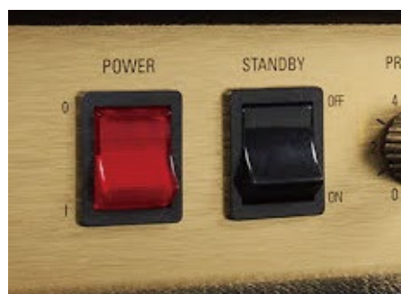
▲STANDBY スイッチはアンプの回路を保護するため
