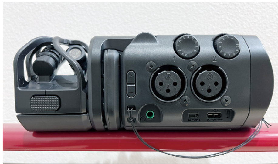
▲本体右側面には外部 XLR 入力端子をはじめ、入力音を直感的に調節できるダイヤルノブや HDMI 出力端子などを搭載
