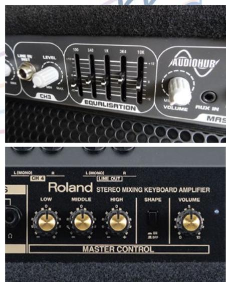
写真2 キーボード・アンプのEQ（上）とマスター・コントロール（下）。ツマミを触りながら音の聴こえ方を確認しよう
