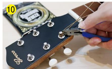
10 ニッパーを使い、ペグの軸付近で余計な弦をカットします。
