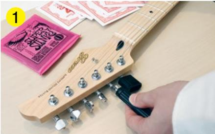
1 まずは、ペグを回してすべての弦を緩めていきましょう。ストリング・ワインダーを使うと、手で回すより圧倒的に速くペグを回せて便利です。
