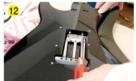
12 同じようにオクターブ・チューニングも合わせます。弦のゲージを変えた場合は、ボディ裏のスプリングを回してブリッジがフローティングするように調整します。
