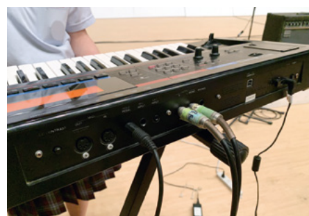
▲キーボードはDIを2つ使ってステレオで出力します
