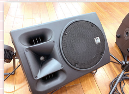
⑦ PAスピーカーをフロア用（足元）のモニタースピーカーとして使用しているケース。各パートのメンバーの立ち位置に合わせて向きを調整しよう
