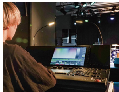
▲調光卓を使用して、灯体をコントロールします
